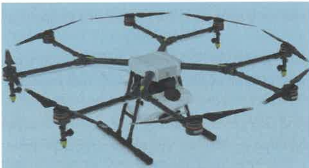
121. Drone με γεωργικό ψεκαστικό εξοπλισμό.
