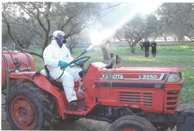
133. Δεν έχει ανοίξει η τρύπα στο μπέκ με αποτέλεσμα το Ψ.Υ. (διάλυμα) να εξέρχεται με μεγάλη πίεση η οποία δημιουργεί μεγάλη διασπορά του Ψ.Υ. και γρήγορη αποξήρασή του.
