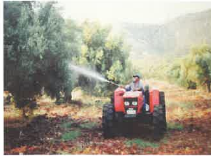
124. Αντικανονική ροή Ψ.Υ. Μεγάλη πίεση. Έλλειψη προστασίας ψεκαστή.
