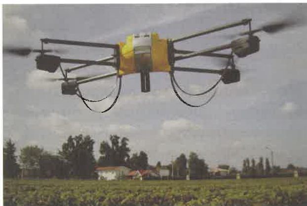
141. Ψεκασμός αμπελώνων με drone.
