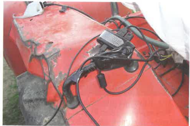
132. Μηχανισμός που συνδέεται με τον αυλό ψεκασμού και ρυθμίζει ώστε η δόση του διαλύματος που πέφτει σε κάθε ψεκαζόμενο δένδρο να είναι 300-350 ml. (344)
