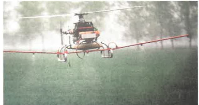
122. Τα ψεκαστικά drones κινέζικης προέλευσης έχουν τη μορφή μικρού ελικοπτερόου και μεγαλύτερες δυνατότητες ανύψωσης βαρών.
